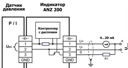
Подключение исполнения прибора с релейным выходом
