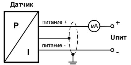
2-проводная линия (выходной сигнал – ток)
