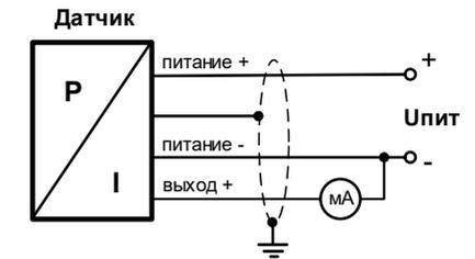
3-проводная линия (выходной сигнал – ток)
