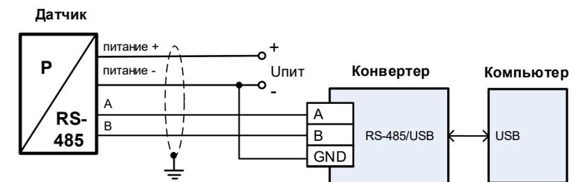
4-проводная линия (выходной сигнал – RS-485)
