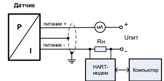
2-проводная линия (выходной сигнал – ток и HART)
