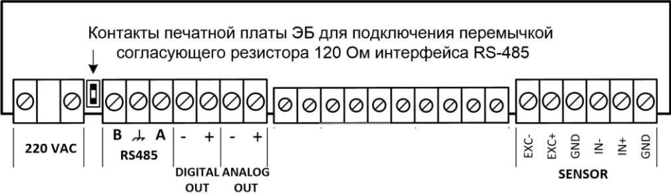
Рисунок Г.1 – Расположение контактов на клеммной колодке ЭБ (раздельное исполнение, перемычка для согласующего резистора не установлена)
