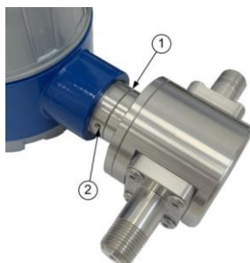
Рисунок 5.1 – Поворот корпуса ЭБ вокруг оси по резьбе (1) с фиксацией штифтом (2)
