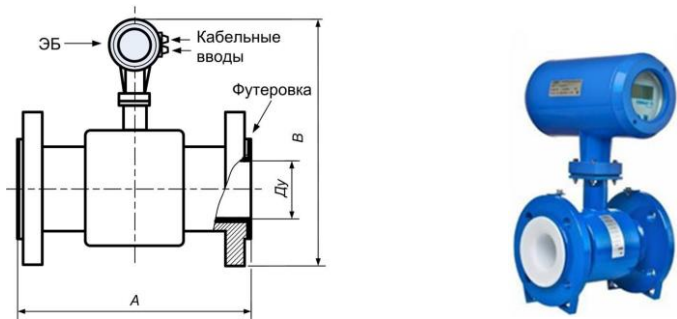
Рисунок Б.3 – Вид конструкции сенсора с установленным ЭБ
